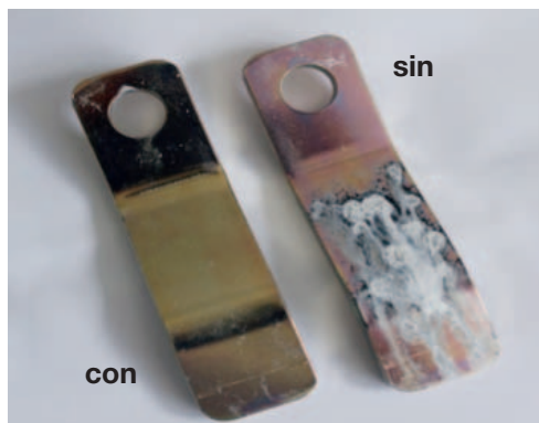
TOPAS 3100 + PROSEAL XZ 111 (+ PROSEAL Nanoaditivo) + SURFASEAL WL 150 después de 840 h en DIN EN ISO 9227
