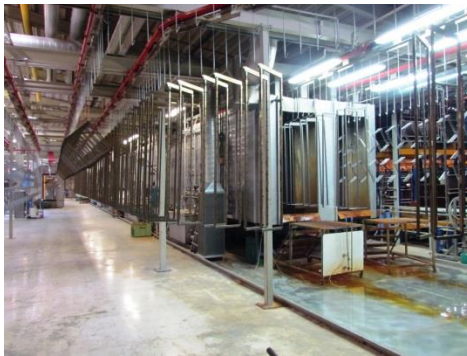
Vista de la instalación de pretratamiento en Kesseböhmer: Las ventajas del proceso optimizado de pretratamiento son, una adherencia mejor de la capa de pintura, una reducción del lodo y una temperatura de trabajo que nos permite ahorrar energía.
